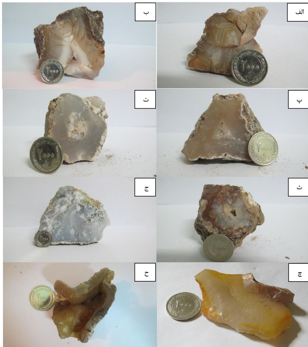
شکل ۲. الف- ساخت ستاره ای نوع متحدالمرکز با باند های منحنی. ب- ساخت ستاره ای نوع مثلثی که مرکز آن به صورت حفره خالی است. پ- ساخت ستاره ای نوع مثلثی که مرکز آن توسط کوارتز درشت بلور پر شده است. ت- ساخت حلقوی که مرکز آن کوارتز درشت بلور قرار دارد. ث- ساخت حلقوی که مرکز آن به صورت حفره خالی است. ج- ساخت توده ای. چ- ساخت موزاییکی. ح- ساخت گل کلمی.
