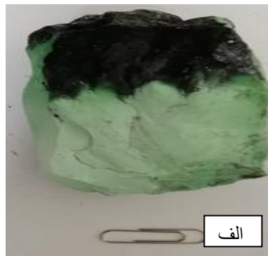
شکل ۱- الف: نمونه ی دستی واریسکایت خالص ب: نمونه دستی واریسکایت رگه دار (عنکبوتی). همان طور که مشخص است این نمونه دارای رگه های شیلی مشکی میباشد
